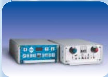
Le boîtier électronique est simple d'utilisation et permet de régler facilement la température et le temps d'impression. Il existe également en option un boîtier à affichage digital permettant d'entrer la valeur exacte souhaitée pour la température et le temps d'impression. Il est aussi équipé de sorties défaut ; fin de ruban, porte ouverte, thermistance et résistance défectueuses.
